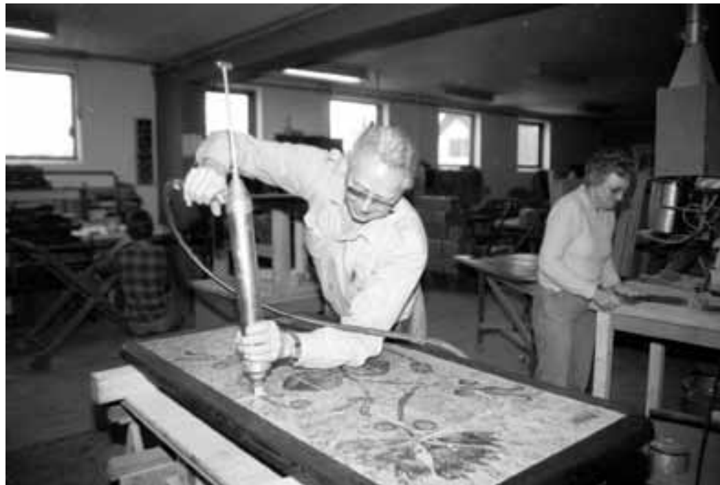
Til venstre: Poul Kyrping på værkstedet i færd med at fuge et kak- kelbord. I baggrunden ses Grethe Kyrping.
